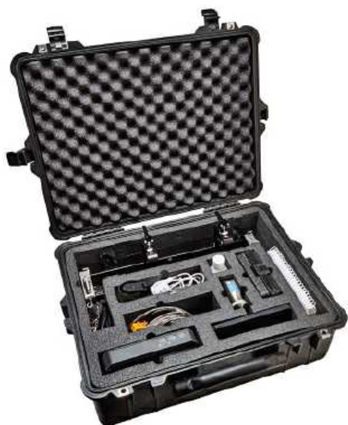
Система PT90 в твердом корпусе для переноски / Зажимное устройство с преобразователями CRR
