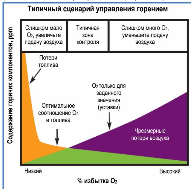
В таких применениях обычно подача воздуха в горелку осуществляется с избытком по сравнению с оптимальным уровнем для обеспечения полного сгорания топлива. Снижение избытка кислорода снижает затраты на топливо за счет повышения эффективности процесса горения.
