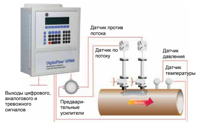
Типичная схема подключения прибора для измерения объемного или углеводородного массового расхода
